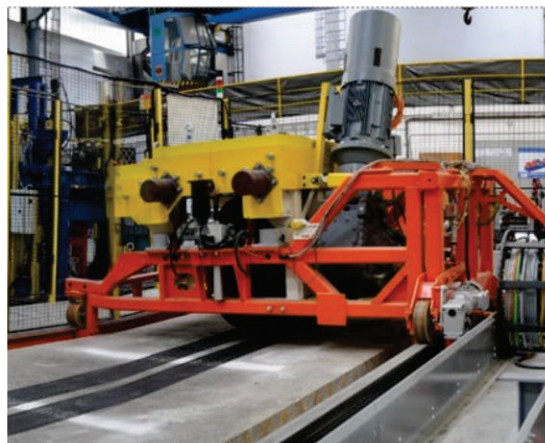
Obr. 8. Zrýchlené testovanie vozoviek
