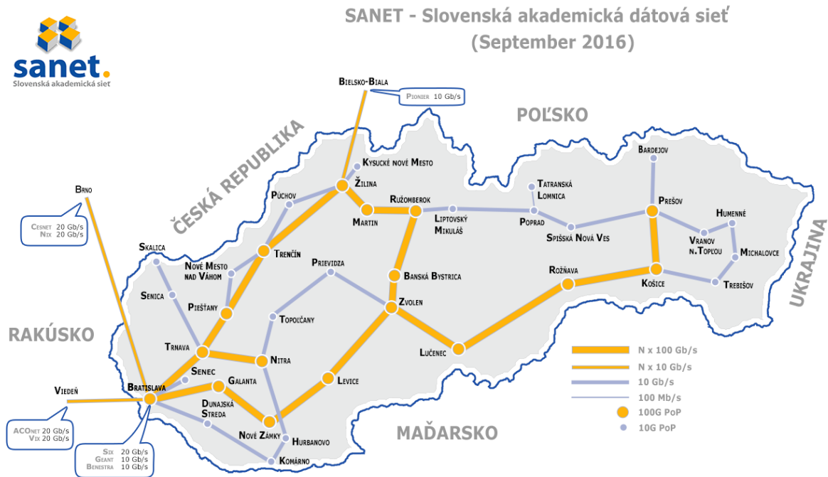
Obr. č. 1 Topológia optického backbone SANET.
